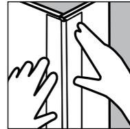
Mesurez la longueur de cornière nécessaire et coupez-la. Pour obtenir un bon ajustement, comptez environ 1/4 po de moins que la hauteur du mur, du sol au plafond. Avec un couteau de 7 po, appliquez une bonne quantité de composé à joints Easi-Fil de chaque côté du coin. En exerçant une pression uniforme, placez la cornière papier-métal sur le coin en vous assurant qu'elle est bien alignée, puis enrobez-la dans le composé en passant le couteau à un angle
