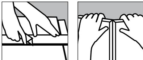
Les cloisons sèches CertainTeed sont très faciles à utiliser et à couper. Pour cela, faites une incision dans le papier du côté face avec un couteau tout usage et une équerre en T. Exercez une pression ferme et uniforme pour casser le panneau le long de la ligne et coupez le papier de l'autre face tout le long du sillon. Enfin, adoucissez les bords avec un bloc de ponçage ou une râpe pour cloisons sèches.
